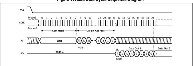
Figure-7. Read Data Bytes Sequence Diagram
